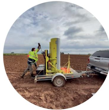
**En amont des travaux, l'étude des sols est indispensable pour déterminer la capacité du sol et du sous-sol à accueillir le Canal et ses ouvrages. Une occasion d'expérimenter la technique innovante de sondages sismiques par réfraction sur le secteur de l'Artois-Cambrésis. Explications.**
