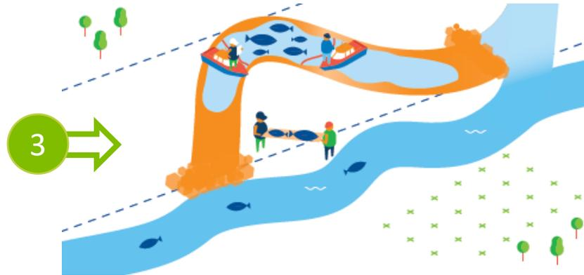
+ 4 - Remblaiement : Les terres issues du creusement sont utilisées pour remblayer l'ancien lit dans l'attente de l'aménagement du Canal.
