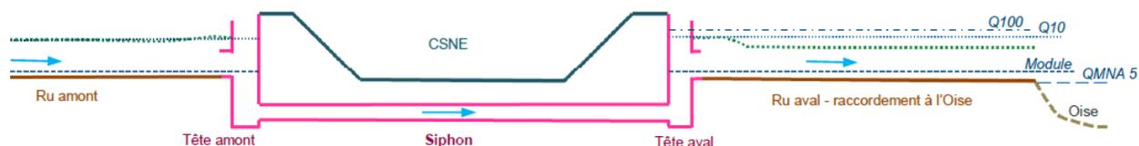
Profil en long schématique d'un ouvrage de traversée (Source : Mémoire technique descriptif des modifications des autres cours d'eau, aqueduc et siphons, Etude de PRO du secteur 1)
