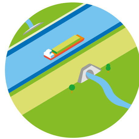
Des aqueducs assurant l'écoulement des cours d'eau
