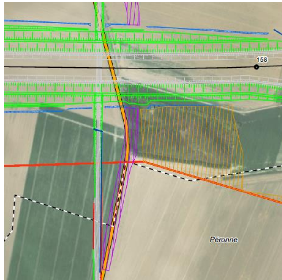
Figure 36 : modification du rétablissement de la D4164 (en violet les emprises APSM, en vert les emprises AVP)
