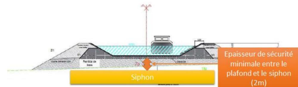
Figure 29 : Distance de sécurité minimale entre le plafond et le siphon pour garantir l'intégrité de ce dernier en cas d'avarie sur le canal (Source illustration : SCSNE, 2019)
