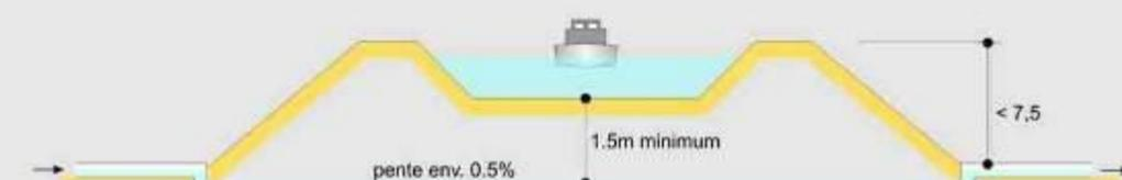
Lorsque le canal est **en remblai**, hormis la Somme qui sera franchie par un pont-canal, les cours d'eau, les écoulements intermittents et les vallons secs seront traversés selon la règle
