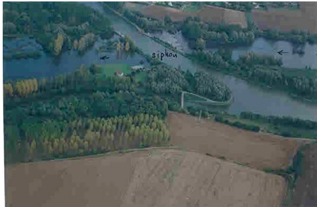
Photo 3 : Passage en siphon de la Somme sous le canal du Nord (Source : Ingerop)
