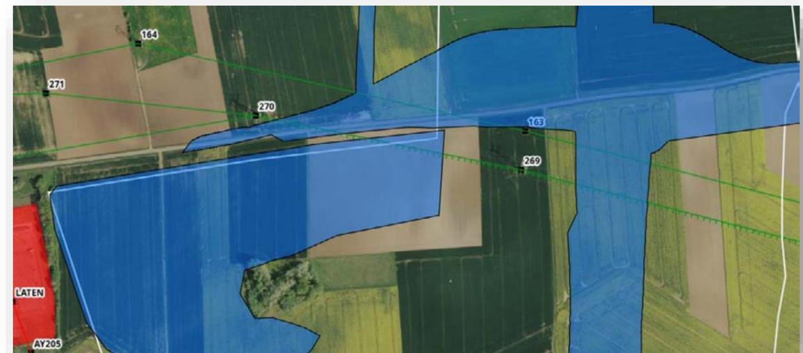
Sur cette zone, il convient donc de rehausser les câbles de la ligne afin de rendre la distance entre les câbles et les eaux du canal compatible avec la réglementation en vigueur (Arrêté Technique de 2001).
