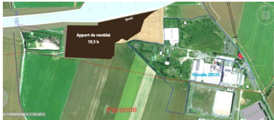
Figure 158 : Apport de remblai pour le port intérieur de Péronne
