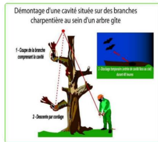
Figure 23 : Schéma présentant les précautions à prendre en cas d'abattage par démontage manuel assisté (Source : Biotope)
