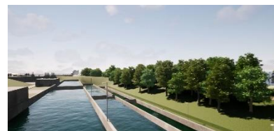
Exemple de bassins d'épargne d'une écluse
