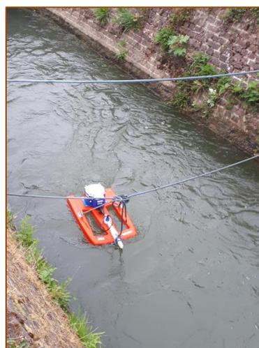
Exemple de profil de vitesse mesurées le 13/2018 avec les vannes (vers écluse et vers port) ouvertes au maximum.
