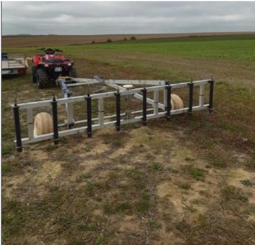
Exemple de véhicule utilisé pour la détection ferro magnétique
